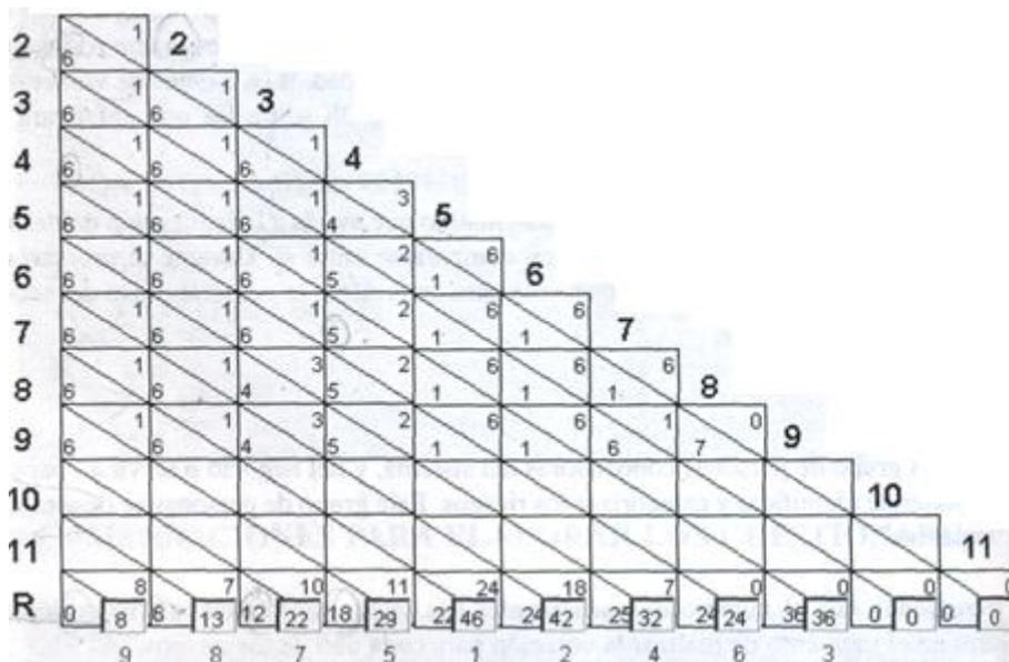
A cada uno de los riesgos seleccionados se le asigna un número. Estos números se ubican tanto en la parte izquierda de cada fila como en la parte superior de la columna. Cada celda se divide en "a" y "b" en "b" se registra el valor de la filas y en "a" el de las columnas.
